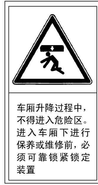
图4 车厢升降过程中,不得进入危险区。 进入车厢下进行保养或维修前, 必须可靠锁紧锁定装置
