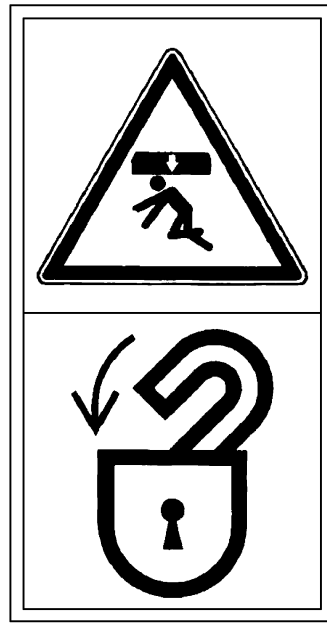
图3 车厢升降过程中,不得进入危险区。 进入车厢下进行保养或维修前, 必须插上安全锁定装置
